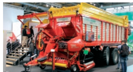
TORRO 8010 D COMBILINE je nový největší model víceúčelových návěsů střední třídy. Podvozek TRIDEM měl nucené řízení první a třetí nápravy a zvedatelnou nápravu první. Zajímavě byl prezentován příčný výkyv sběrače, výkyvný nosník nožů EASY MOVE s noži TWINBLADE a brouscí zařízení AUTOCUT.
