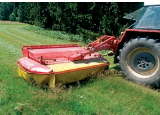
Boční žací stroj NOVACAT 265 H ED s prstovým lamačem vyžívá družstvo deset let.
