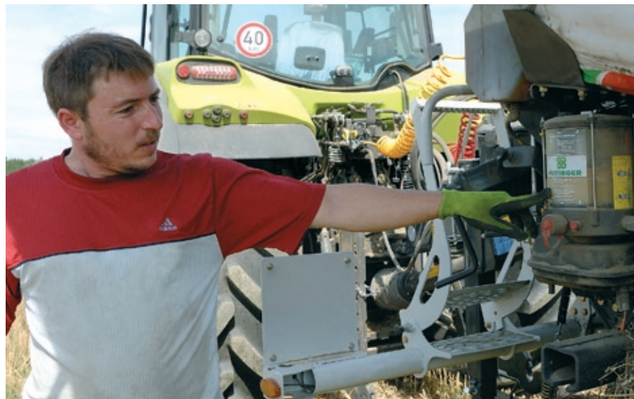
Obsluha každého lisu má nezastupitelný vliv na výkonnost a provozní spolehlivost. Nároky na údržbu výrazně snižuje centrální mazání, které dodává mazací tuk k ložiskům v průběhu lisování. Množství tuku a časování dávkování je nastavitelné, což oceňuje Aleš Smutný, který s lisem IMPRESS pracuje.
