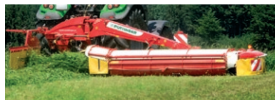
Diskový žací stroj NOVACAT 352 CF s příčným šnekovým dopravníkem přináší úspory PHM a času. Nejdůležitějším faktorem je však minimalizace znečištění píce a ztrát odrolem. To se následně projevuje ve zlepšení kvality krmné dávky skotu.
