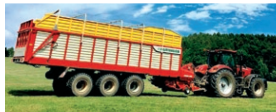
Veľkoobjemový senážny voz JUMBO 8010 L s trojnápravovým podvozkom TRIDEM.
