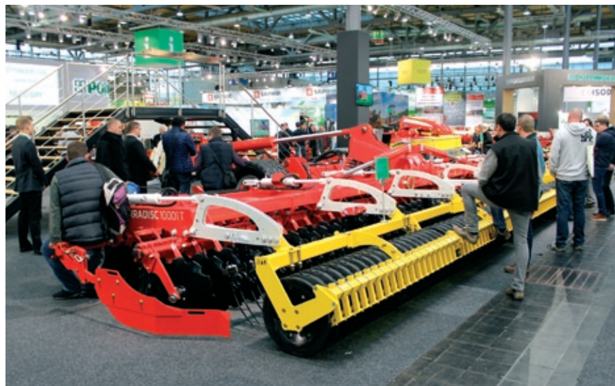
Firma Pöttinger uvádí pro rok 2018 své talířové podmítače v záběrech osmi a deseti metrů. Nové typy TERRADISC 8001 T a 10001 T mají podvozek před pracovními sekcemi a odpružený opěrný válec.
