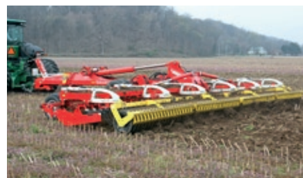
S novými talířovými bránami TERRADISC 8001 T a 10001 T lze při podmítkách či přípravě půdy dosahovat výkonnosti více než 100 hektarů za prodlouženou směnu. Podmítače se vyznačují vysokou průchodností.
