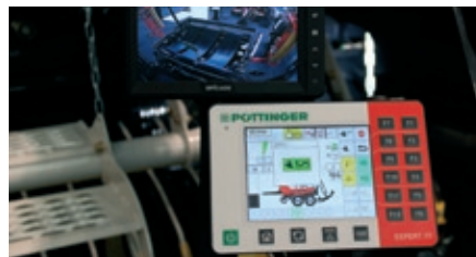
Nový terminál EXPERT 75 firmy Pöttinger má kromě barevné obrazovky ještě ovládací lištu tlačítek, na níž lze stroj jednoduše ovládat pravou rukou.
