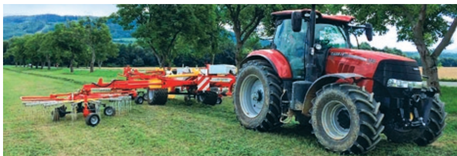
Štvorrotorový zhrňovač TOP 1252 pre tvorbu stredového riadku s nastaviteľným záberom 8 – 12,5 m.
