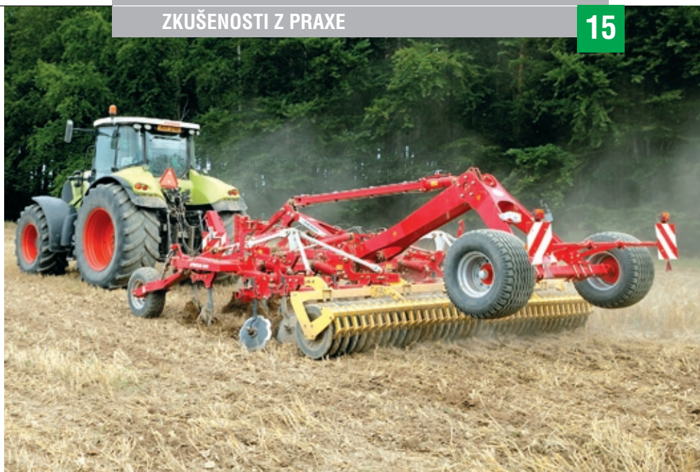
Radličkový podmiřák SYNKRO 5030 T NOVA v agregaci s traktorem 250 k a s obsluhou Karlem Hebelkou při zpracování pozemku po sklizni ozimé pšenice do hloubky asi 8 cm.
