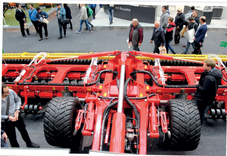
Lafetový podvozek se speciálním systémem sklápění do přepravní polohy dovoluje u Terradiscu 10001 T přepravní výšku jen čtyř metrů se šířkou pouhých tří metrů. V pracovní poloze mohou jednotlivé sekce kopírovat povrch pozemku
