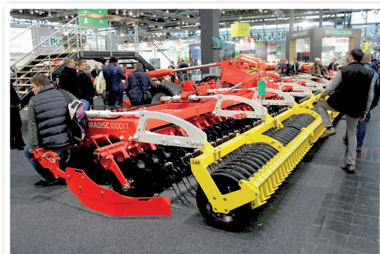
Firma Pöttinger uvádí pro rok 2018 své talířové podmítače v záběrech osmi a deseti metrů. Nové typy Terradisc 80001 T a 10001 T mají podvozek před pracovními sekcemi a odpružený opěrný válec
