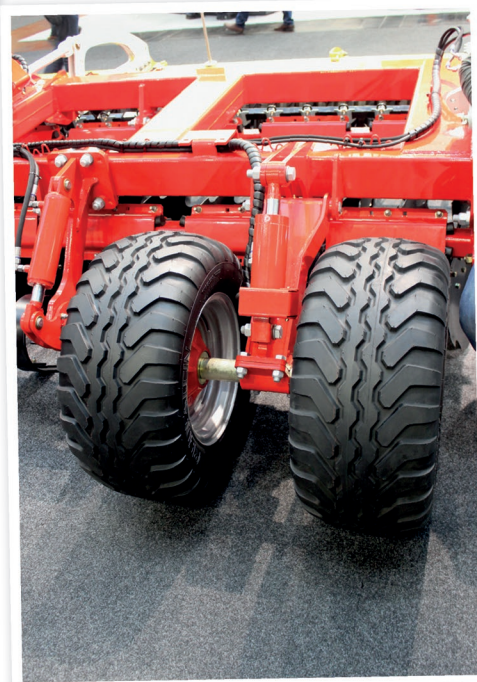
Větší typ Terradisc 10001 T je standardně vybaven předními kopírovacími koly, pro Terradisc 80001 T jsou tato kola nabízena na přání. Centrální hydraulické nastavení pracovní hloubky talířů je propojeno mezi opěrnými válci a předními koly
