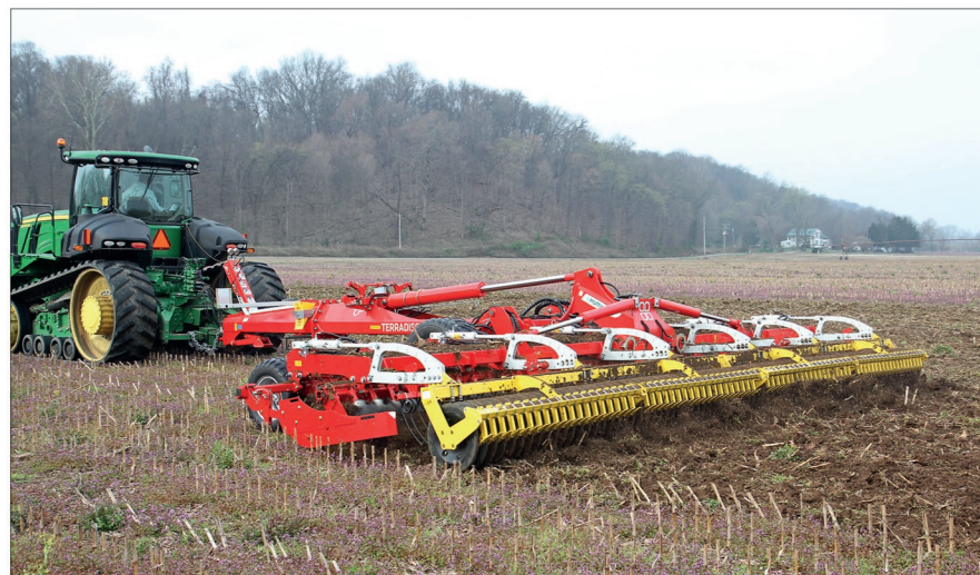
S novými talířovými bránami Terradisc 80001 T a 10001 T lze při podmínkách či přípravě půdy dosahovat výkonnosti více než 100 hektarů za prodlouženou směnu. Podmiťáče se vyznačují vysokou průchodností
