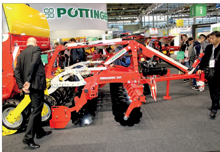
Výhodou konceptu Multiline firmy Pöttinger je také to, že stroj pro zpracování půdy i secí stroj lze využívat samostatně. Odpojení secího stroje zabere jen několik minut
