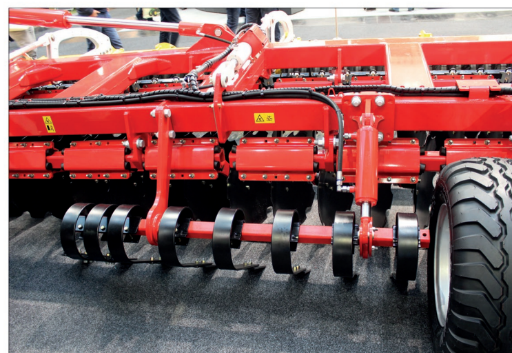
Při využití nových podmiťáčů Terradisc T pro přípravu půdy před setím přijde vhod přední smykací lišta s nastavitelnou agresivitou
