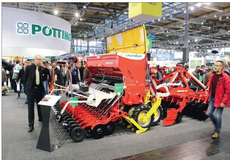
Koncept Multiline druhé generace je osazen zcela nově koncipovaným pneumatikovým válcem, v němž jsou jednotlivá kola uložena přesazeně. Díky tomu se celá souprava pohybuje po poli klidněji a je šetrnější k půdě při otáčení
