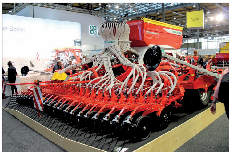
Secí stroje Terrasem odvádí kvalitní práci i při vyšších pojezdových rychlostech, což je dáno také efektivním kopírováním terénu secími botkami. Praxe oceňuje možnost změny výsevu za jízdy v krocích po deseti procentech. Množství prosetého osiva je minimální
