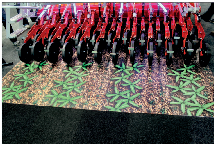
Secí stroj Aerosem 3002 ADD umí nově nabídnout setí kukuřice do dvojřádku v technologii Duplex Seed. Organizace porostu do dvojřádku poskytuje jednotlivým rostlinám více světla, vláhy i živin
