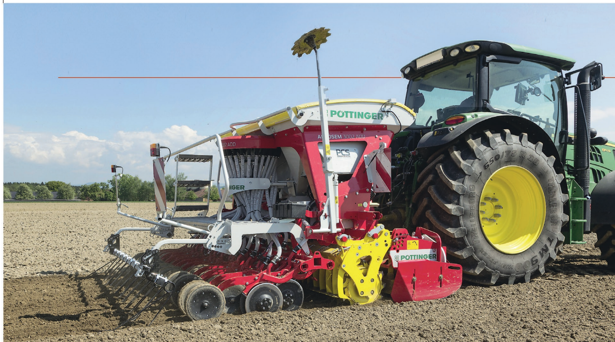
U secího stroje Aerosem 3002 ADD v provedení s inteligentní rozdělovací hlavou IDS se o zavírání semenovodných hadic starají dálkově ovládané elektromotorky, takže lze pohodlně z kabiny traktoru nastavovat rytmus kolejších mezířádků, volit jejich různou šířku či vypínat polovinu pracovního záběru výsevní lišty
