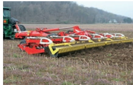
S novými talířovými bránami TERRADISC 8001 T a 10001 T lze při podmiťkách či přípravě půdy dosahovat výkonnosti více než 100 hektarů za prodlouženou směnu. Podmiťače se vyznačují vysokou průchodností.
