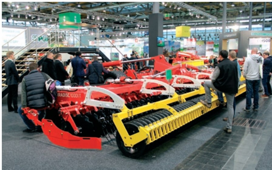
Firma Pöttinger uvádí pro rok 2018 své talířové podmiťače v záběrech osmi a deseti metrů. Nové typy TERRADISC 8001 T a 10001 T mají podvozek před pracovními sekcemi a odpružený opěrný válec.
