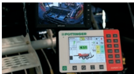
Nový terminál EXPERT 75 firmy Pöttinger má kromě barevné obrazovky ještě ovládací lištu tlačítek, na ní lze stroj jednoduše ovládat pravou rukou.
