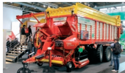
TORRO 8010 D COMBILINE je nový největší model víceúčelových návěsů střední třídy. Podvozek TRIDEM měl nucené řízení první a třetí nápravy a zvedatelnou nápravu první. Zajímavě byl prezentován příčný výkyv sběrače, výkyvný nosník nožů EASY MOVE s noži TWINBLADE a brousicí zařízení AUTOCUT.
