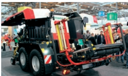
Ovíječka je konstruována nově tak, aby byla speciálně přizpůsobená vysokému výkonu lisu IMPRESS.
