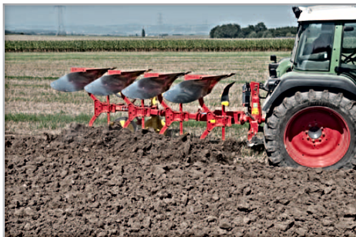
Konstrukce pluhu garantuje kvalitní orbu a provozní spolehlivost při agregaci s traktory s maximálním výkonem 120 koní
