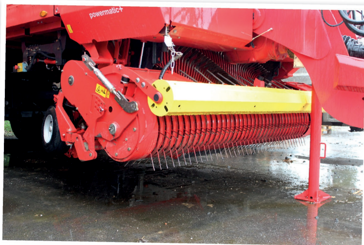
Široký sběrač návěsu Jumbo 7210 L Combiline zvládá sběr i širokých či zakřivených řádků na nepravidelných pozemcích. Kopírování terénu je díky výkvnému zavěšení na výborné úrovni. Sběrač je šetrný k povrchu půdy i při projíždění zatáček
