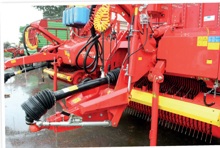
Návěs Jumbo 7210 L Combiline je vybaven elektrohydraulickým řízením náprav, které vozu poskytuje vynikající manévrovatelnost. Řízení funguje v závislosti na jezdové rychlosti. Díky úzké oji se traktor může k návěsu natočit ve velkém úhlu
