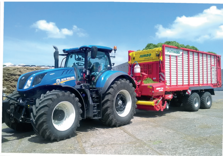
Návěs Jumbo 7210 L Combiline pracuje s traktorem New Holland T7.315 HD při velmi malé energetické náročnosti. Velkou výhodou je komfortní chování návěsu díky hydropneumatickému odpružení tandemového podvozku
