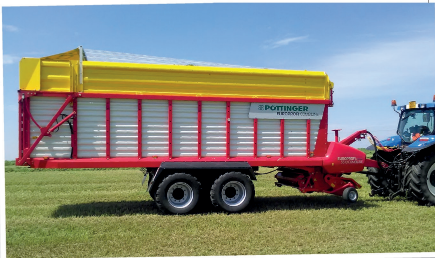
Návěsy Europrofi Combiline se vyznačují stabilní rámovou konstrukcí pro velká zatěžování. Spirálový vkládací rotor o průměru 800 mm spolu s řezacím ústrojím, osazeným 35 noži, zajišťují rovnoměrné zkrácení píce na požadovanou délku
