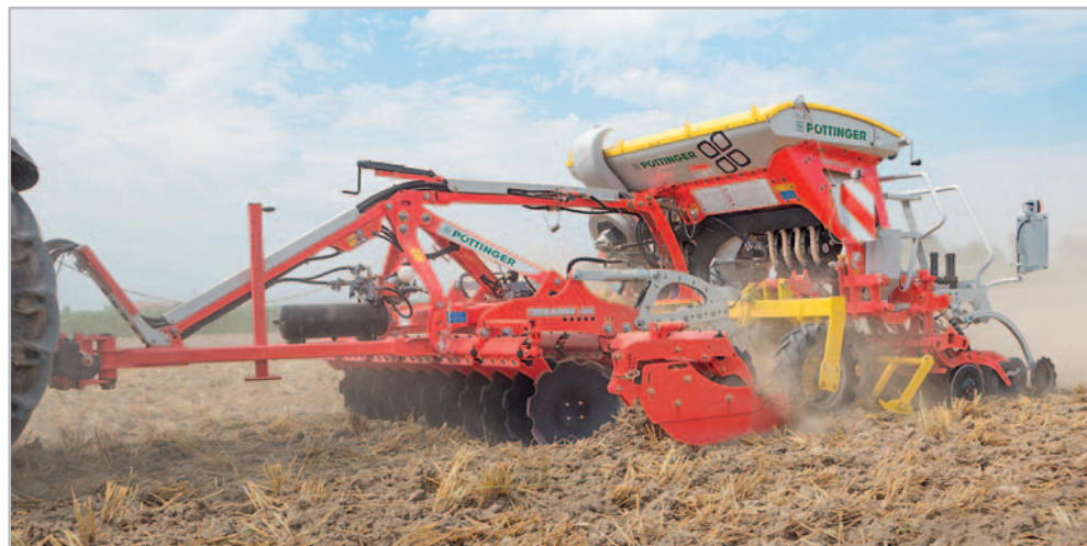
Místo talířových bran Terradisc může být Multiline agregován i s radličkovým kypřičem Synkro řady 1030 o záběru tři nebo čtyři metry, zrovna tak lze připojit nejen mechanický secí stroj Vitasem, ale také pneumatikový secí stroj Aerosem ADD
