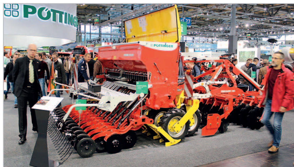
Koncept Multiline druhé generace je osazen zcela nově koncipovaným pneumatikovým válcem, v němž jsou jednotlivá kola uložena přesazeně. Díky tomu se celá souprava pohybuje po poli klidněji a je šetrnější k půdě při otáčení
