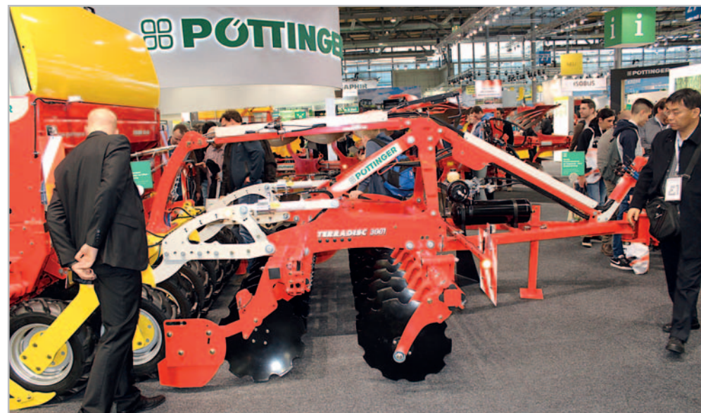
Výhodou konceptu Multiline firmy Pöttinger je také to, že stroj pro zpracování půdy i secí stroj lze využívat samostatně. Odpojení secího stroje zabere jen několik minut
