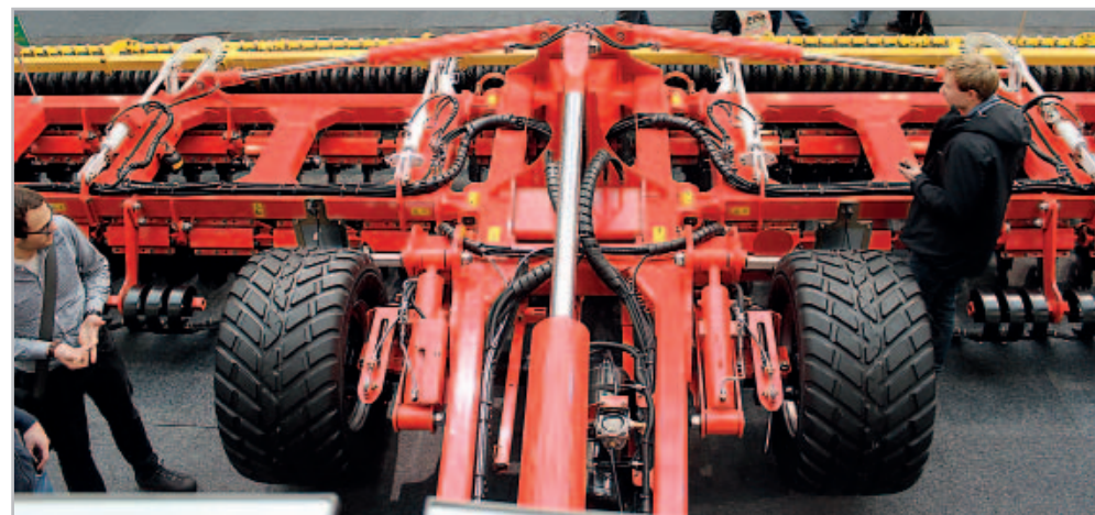
Lafetový podvozek se speciálním systémem sklápění do přepravní polohy dovolují u Terradiscu 10001 T přepravní výšku jen čtyři metry se šířkou pouhé tři metry. V pracovní poloze mohou jednotlivé sekce kopírovat povrch pozemku Foto Petr Beneš
