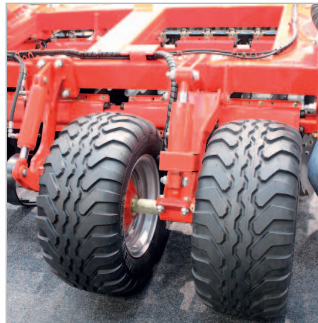
Větší typ Terradisc 10001 T je standardně vybaven předními kopírovacími koly, pro Terradisc 80001 T jsou tato kola nabízena na přání. Centrální hydraulické nastavení pracovní hloubky talířů je propojeno mezi opěrnými válci a předními koly Foto Petr Beneš
