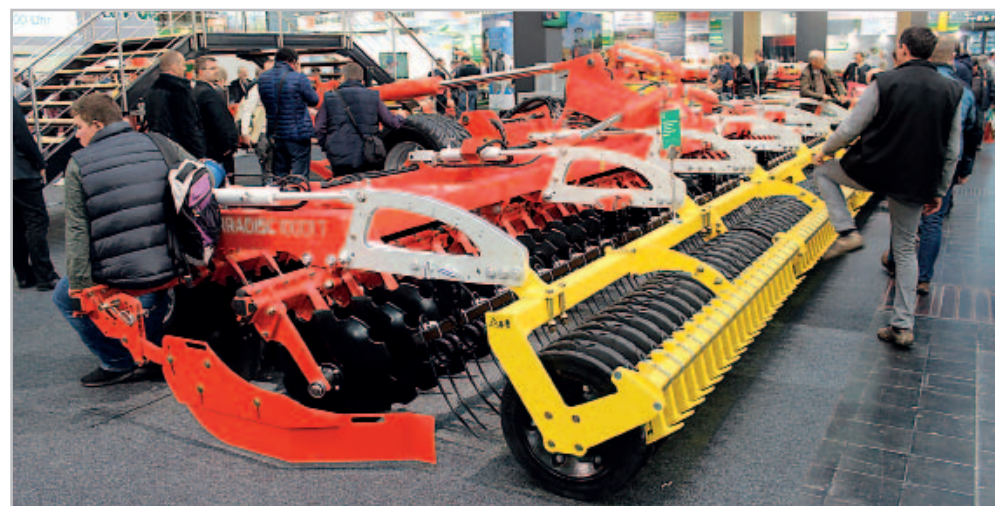
Firma Pöttinger uvádí pro rok 2018 své talířové podmiťáče v záběrech osm a deset metrů. Nové typy Terradisc 80001 T a 10001 T mají podvozek před pracovními sekcemi a odpružený opěrný válec Foto Petr Beneš
