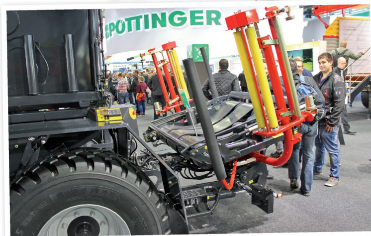
Ovíječka má vysoký stupeň všestrannosti v závislosti na průměru balíků (od 1,1 m do 1,5 m) a požadovaném počtu ovinutí i překrytí fólie. Pro ovinutí slouží dvě ramena s otáčkami 36 ot/min se spodním uložením, u nichž je výměna rolí fólie jednoduchá díky jejich nízké výšce
