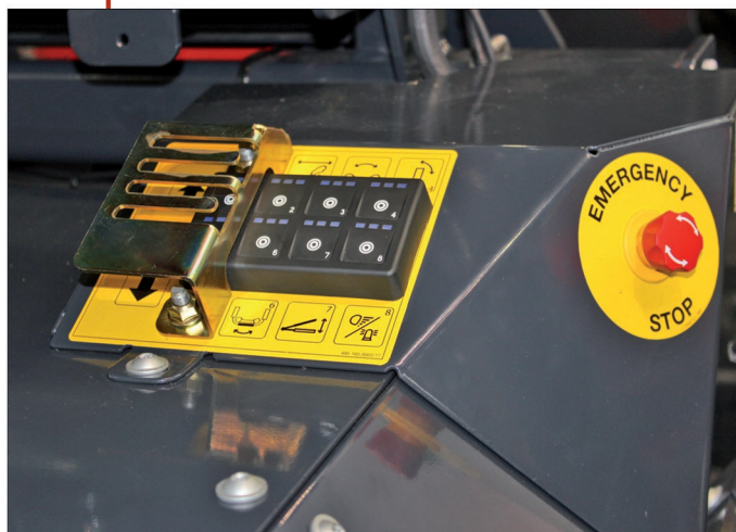
Ovíječka má postranní panel, na němž lze pomocí tlačítek ovládat její nejdůležitější funkce. Levá řada tlačítek má zabezpečení proti nechtěnému spuštění. Při otočení nouzovým ovladačem vpravo se ihned zastaví všechny funkce ovíječky
