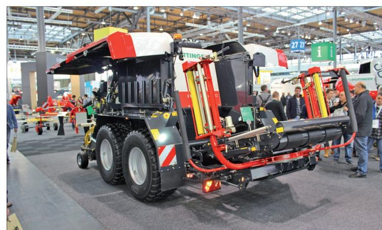
*Ověječka je konstruována nově tak, aby byla speciálně přizpůsobená vysokému výkonu lisu Impress. Dovoluje provádět dvě operace při jednom přejezdu, případně lze až dva balíky převézt na požadované místo na poli*
