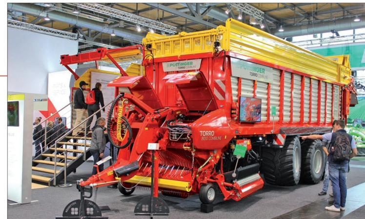
Torro 8010 D Combiline je nový největší model víceúčelových návěsů střední třídy Torro Combiline. Podvozek Tridem měl nucené řízení první a třetí nápravy a zvedatelnou nápravu první. Zajímavě byl prezentován přiční výkyp sběrače, výkynný nosník nožů Easy Move s noži Twinblade a brousicí zařízení Autocut
