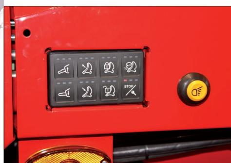
**Nouj stranový ovládací panel** přímo na návěsu Torro Combiline poskytuje rychlý přístup k nejčastěji využívaným funkcím: odjistění a vykloupení nosníku nožů Easy Move, ovládání brousicího zařízení Autocut, zdvihu oje při agregaci s traktorem a podlahového dopravníku
