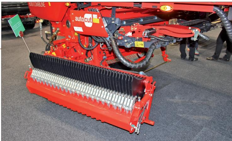
Ve svém stranově výkynném nosníku mají návěsy Torro Combiline 45 nožů Durastar s otěruzdorným povlakem karbidu wolframu. Vysoká tvrdost (50-53 HRC) při tloušťce šesti milimetrů zajišťuje dlouhou životnost nožů. Kvalitní samoostřící nože rovněž zlepšují kvalitu rezanky a snižují energetickou náročnost řezání i spotřebu paliva
