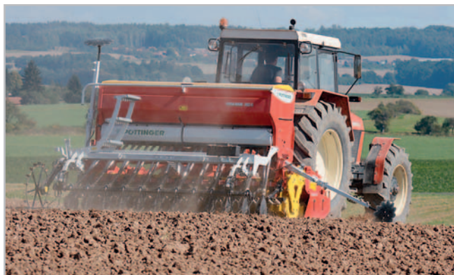
K setí ozimé pšenice a ozimé řepky slouží mechanický secí stroj Vitasem 302 A ve spojení s rotačními bránami Lion 301. Secí stroj je možné od rotačních bran rychle odpojit; při práci je jeho hmotnost přenášena na opěrný válec
