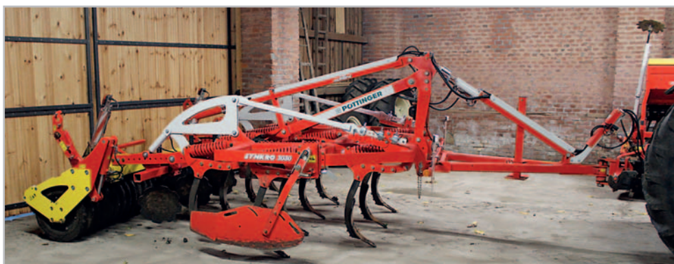
Oproti variantě Terradisc Multiline má Synkro Multiline na své oji přídavnou pístnici, která pomáhá radličkovému kypřiči zvednout. Stroj je osazen hydraulicky ovládanou změnou pracovní hloubky ve standardu. Nicméně podvozek je identický, což umožňuje záměnu radličkového kypřiče za talířové brány před secím strojem
