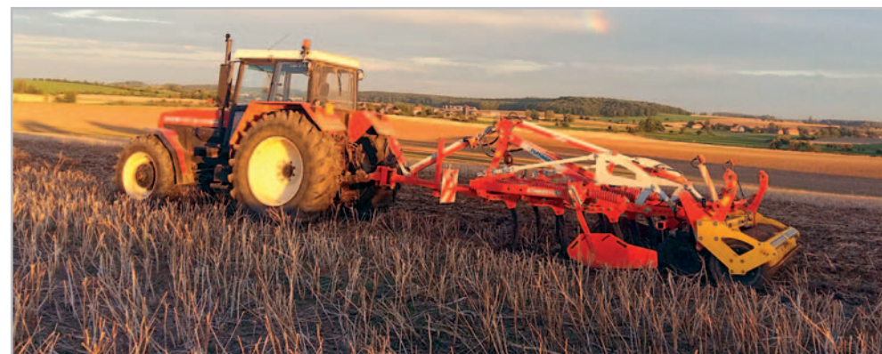
Tahového výkonu má traktor Zetor 16245 dostatek, aby mohl pracovat s kypřičem Synkro 3030 Nova i při kypření do větších hloubek. A díky konceptu Multiline, který promění kypřič o záběru tří metrů na tažený stroj, není třeba řešit otázky zvedací kapacity tříbodového závěsu traktoru. Do závěsu nad opěrným válcem lze ještě připojit secí stroj Vitasem, anebo Aerosem
