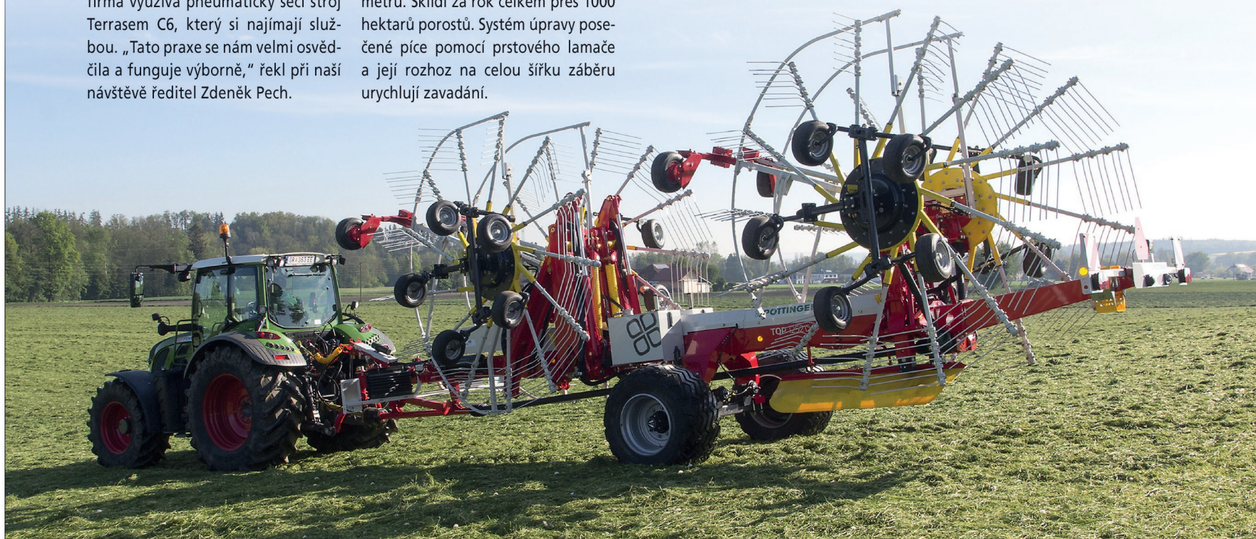
Shrnovač TOP 1252 C má v transportní poloze celkovou výšku 3,99 m bez nutnosti demontáže hrabic, zatímco pracovní záběr může činit až 12,5 m. Pro bezpečný převoz po pozemních komunikacích slouží mechanické zajištění rotorů
