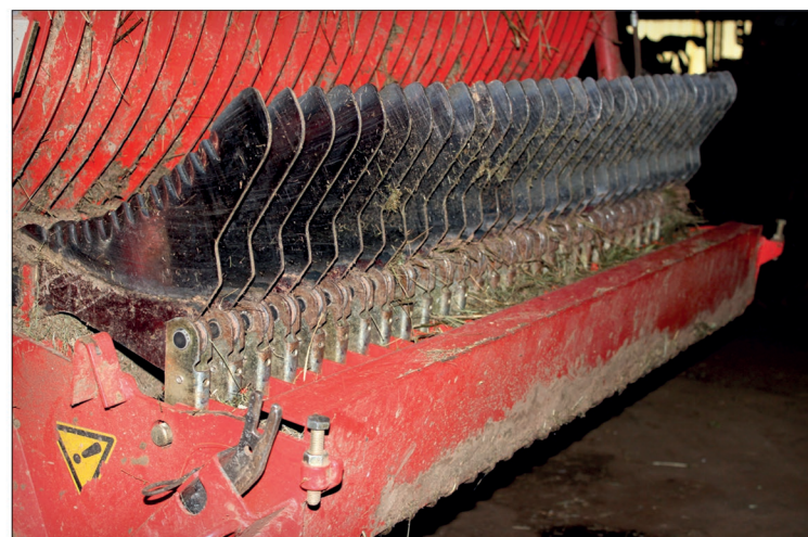
32 nožů ve stranově výklopném nosníku Easy Move návěsu Europrofi 5000 se zaslouhuje o zkrácení píce na řezanku o teoretické délce 45 mm. Nože mají dvojitý jištění – na patě a na špičce
