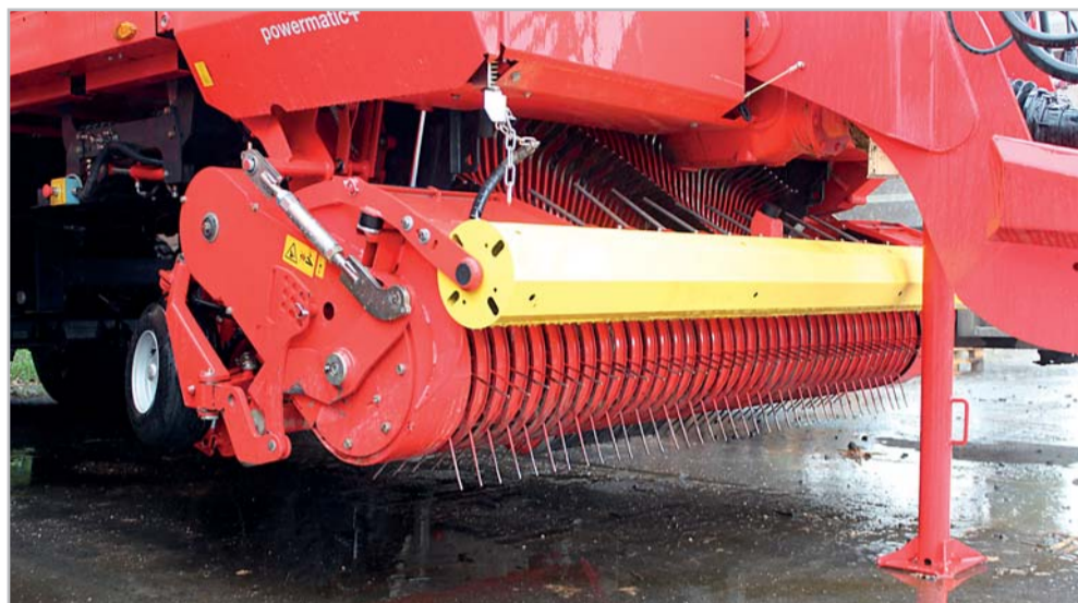
Široký sběrač návěsu Jumbo 7210 L Combiline zvládá sběr i širokých či zakřivených řádků na nepravidelných pozemcích. Kopírování terénu je díky výkyvnému zavěšení na výborné úrovni. Sběrač je šetrný k povrchu půdy i při projíždění zatáček
