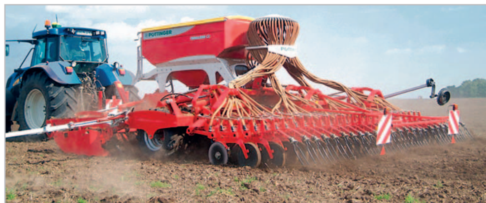
Pneumatický secí stroj Terrasem C6 se osvědčil svou kvalitou setí a rovnoměrnou vzházivostí všech založených porostů, včetně ozimých řep Foto archiv
