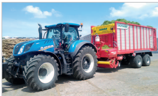
Návěs Jumbo 7210 L Combiline pracuje s traktorem New Holland T7.315 HD při velmi malé energetické náročnosti. Velkou výhodou je komfortní chování návěsu díky hydropneumatickému odpružení tandemového podvozku Foto archiv
