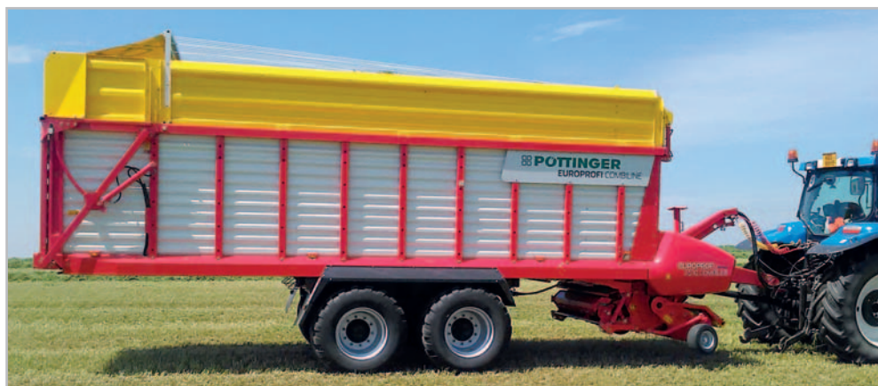
Návěsy Europrofi Combiline se vyznačují stabilní rámovou konstrukcí pro velká zatěžování. Spirálový vkládací rotor o průměru 800 mm spolu s řezacím ústrojím, osazeným 35 noži, zajišťují rovnoměrné zkrácení píce na požadovanou délku Foto archiv
