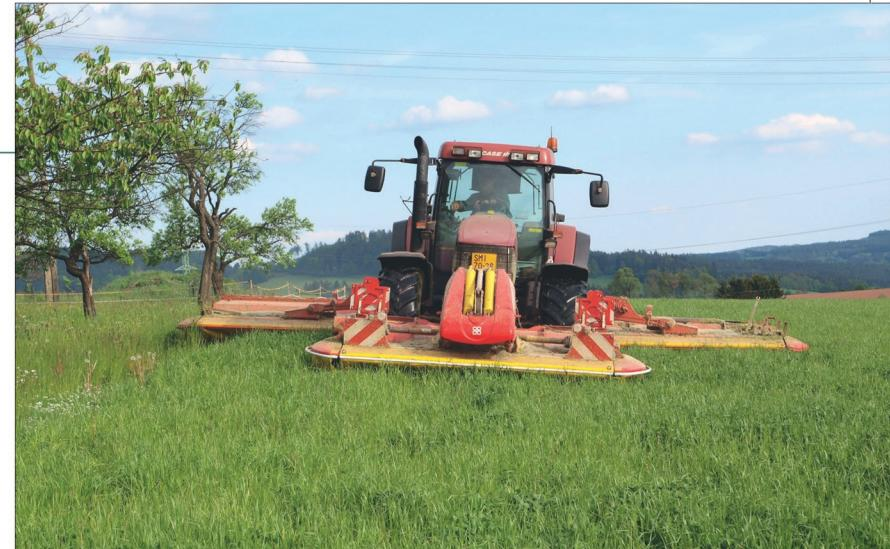
**V aggregaci s traktorem Case IH poseče žací kombinace NovaCat 8600 ED dohromady 1500 až 2000 hektarů ročně. Provádí souběžné narušení hmoty pomocí prstového lamače, přesto spotřeba paliva činí pouze 3,6 l/ha**
