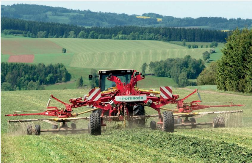
**Středový shrnovač má výhodu v rovnoměrném formování řádku v ideální podobě pro následný sběr senážními návěsy. Pöttinger TOP 972 C s-line má se svými dvěma velkými rotory maximální pracovní záběr 9,8 m a vyžaduje traktor s výkonem od 37 kW/50 k**
