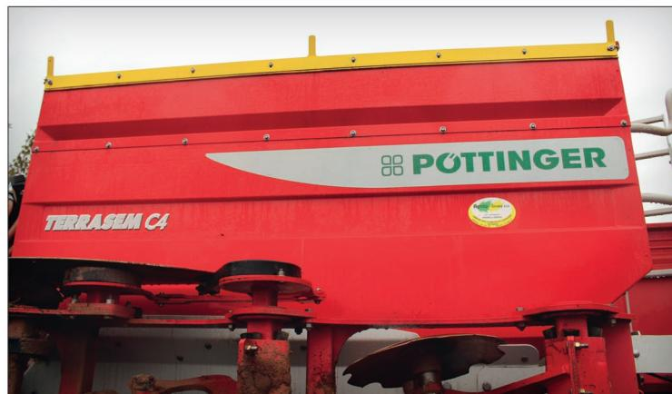
*Zásobník sečích strojů Terrasem má nejenom velký plnící otvor, ale uvnitř také rošt pro zachycení případných cizích předmětů. Stroj Terrasem C4 v DS Agro Libštát disponuje zásobníkem se zvětšeným objemem na 3950 l*
