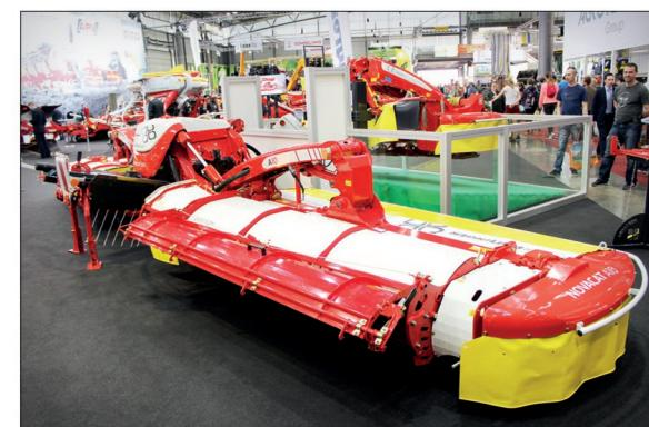
*Další varianta rozšiřuje již bez tak široký sortiment žacích kombinací firmy Pöttinger: NovaCat A10 CF disponuje šnekovými shazovacími dopravníky Cross Flow. Jak je patrné na obrázku, komora dopravníků se směrem do středu rozšiřuje, aby se průchodnost hmoty ještě zvětšila*
