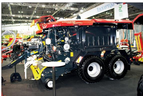
*Každý balík je po slisování ihned zabaleny do folie, což je jedna z předností lisu s integrovanou oviječkou Impress 115 VC Pro. Tato kombinace s lisem s variabilní lisovací komorou umí produkovat balíky o průměru od 1,10 m do 1,50 m*
