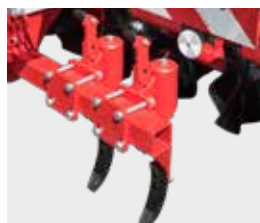
Odpružené kypřiče stop kol traktoru
