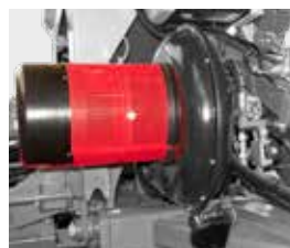
Kryt ventilátoru proti vniknutí prachu
