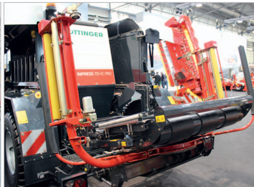
Každý balík je po slisování ihned zabalený do fólie, což je jedna z předností lisu s integrovanou ovíječkou Impress 115 VC Pro. Tato kombinace s lisem s variabilní lisovací komorou umí produkovat balíky o průměru od 1,1 m do 1,5 m
