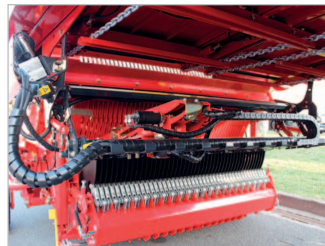
Návěsy řady Torro Combiline jsou v nosníku Easy Move osazeny 45 noži v rozteči 34 mm. Na přání mohou být vybaveny také brouscím zařízením Autocut, které nabrousí automaticky každý nož z obou stran v přestávkách práce anebo po ní
