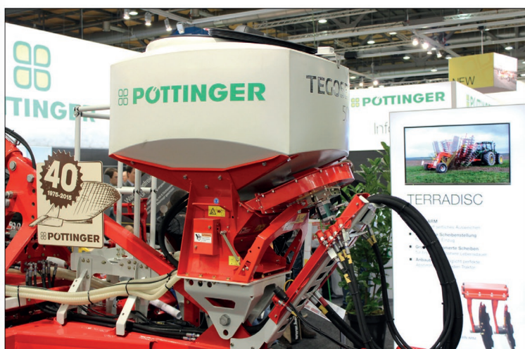
Secí stroje Tegosem, instalované na oji půdozpracujícího nářadí v poloneseném provedení, mají pohon ventilátoru čistě hydraulický
