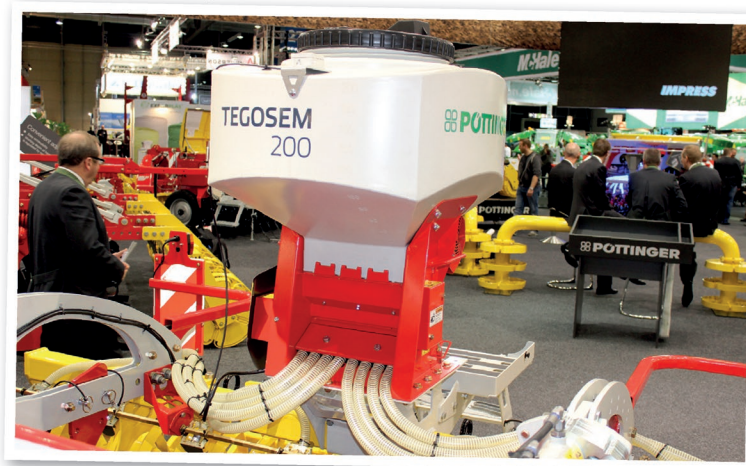
Pöttinger Tegosem se vyrábí se zásobníkem osiva o objemu 200 nebo 500 l. Pro precizní výsev a komfort ovládání je stroj vybaven řadou senzorů
