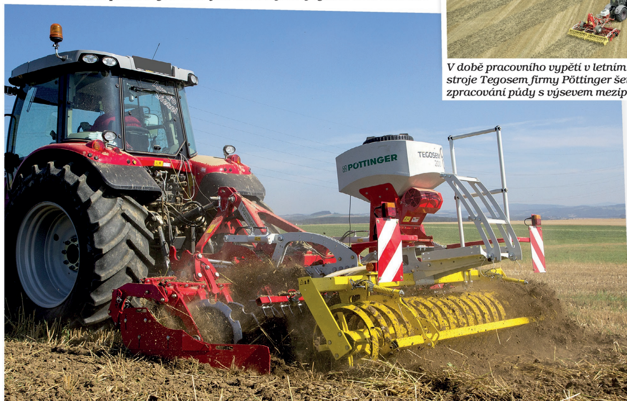
Secí stroj Tegosem je využitelný v kombinaci s krátkými talířovými branami nebo radličkovými kypřiči Pöttinger (či jiných značek) pro výsev meziploidy při jednom přejezdu
