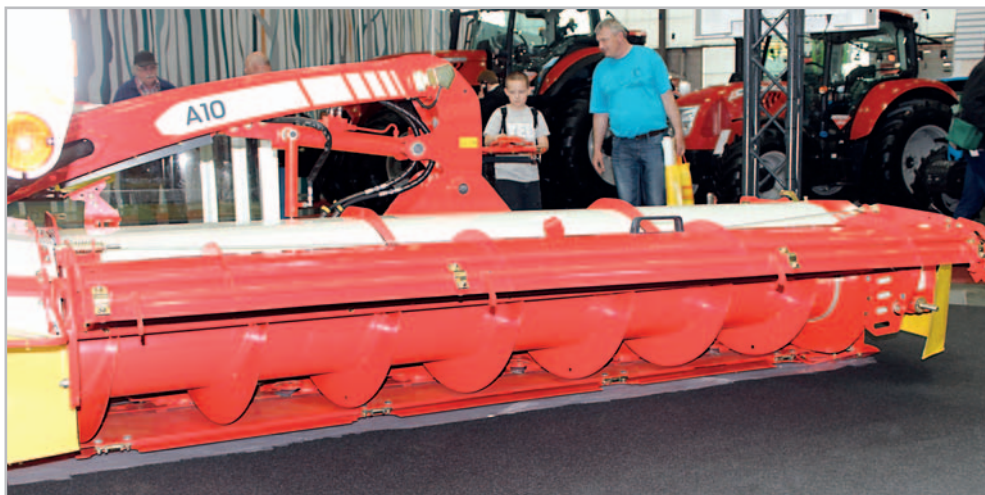
Shazovací šnekový dopravník Cross Flow u žací kombinace NovaCat A10 je koncipován pro maximální výkonnost. Odebírá hmotu přímo od žacích disků, takže představuje spolu se žacími stroji efektivní a kompaktní jednotku
