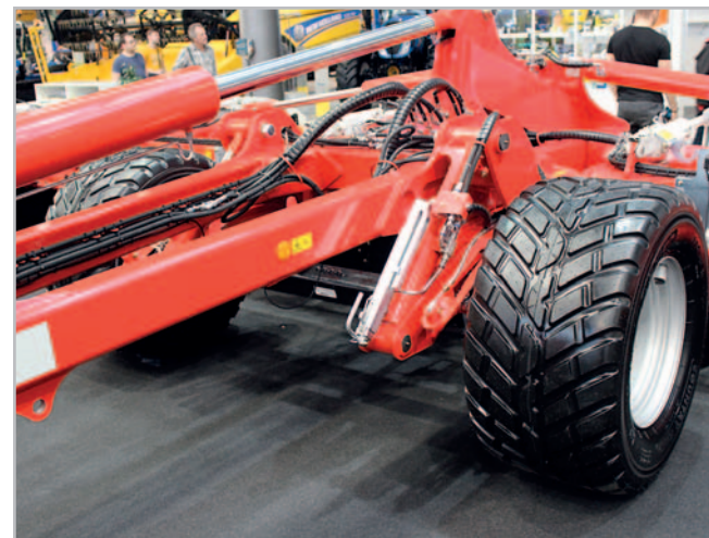
TerraDisc 10001 T disponuje robustním podvozkem s obutím do širokých pneumatik Nokian Country King. Při práci je náprava zvednutá nahoru
