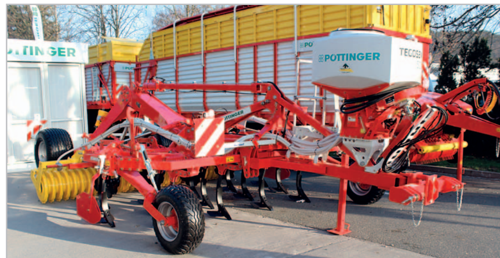
Synkro 4030 T Nova se třemi řadami šípových radliček a řezacím válcem Packer dokáže zabezpečit podmínky či zpracování půdy do hloubky 15–18 cm. Po osazení úzkými radličkami je možné i kypření do větších hloubek. Secí stroj Tegosem dovoluje souběžné setí meziplodin
