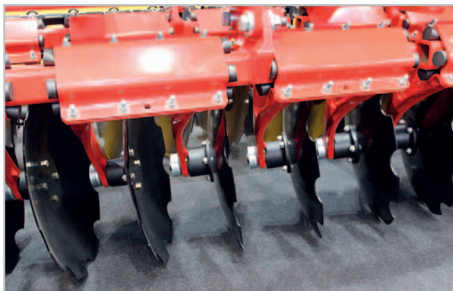
Udržování nastavené pracovní polohy talířů u stroje TerraDisc 10001 T a TerraDisc 8001 T zajišťuje společně uchycení dvou talířů na jedné přírubě v systému Twin Arm. Gumové tlumiče mají na starost jištění proti přetížení
