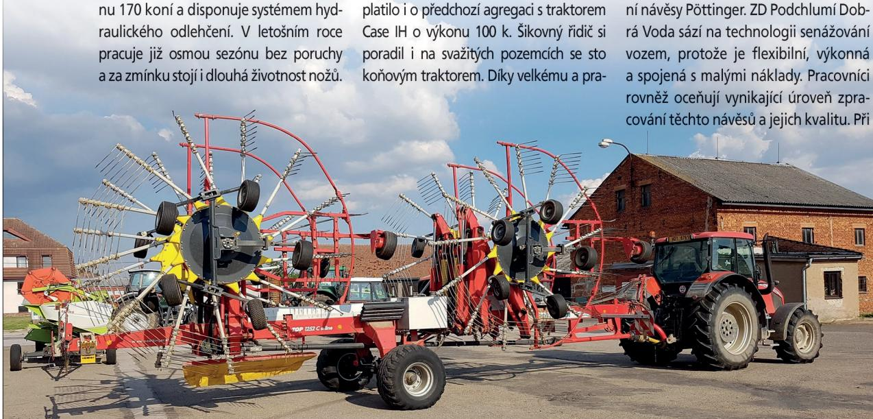
*Největší shrnovač Top 1252 je v současnosti agregován s traktorem o výkonu 135 k, ale pracoval i s traktorem o výkonu 100 k. Kromě dlouhé životnosti prstů si získala uznání také možnost plynule měnit pracovní záběr v průběhu práce*
