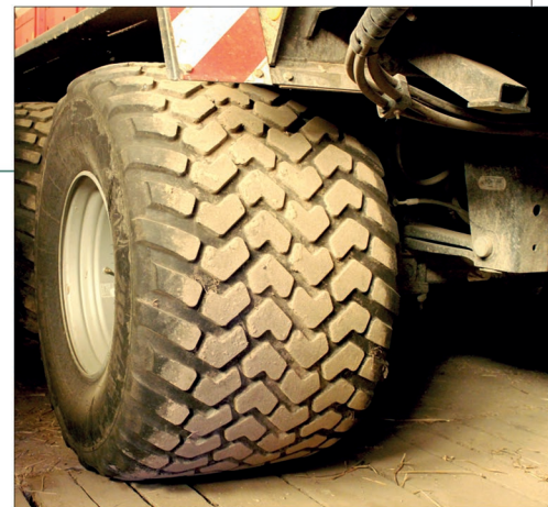
Pneumatiky Michelin na podvozích obou vozů se vyznačují plochým běhounem, a tím i šetrným působením na travní drn, nízkým měrným tlakem na půdu a značnou stabilitou při udržování stopy ve svazích
