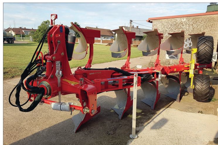
V letošním roce pořídili v podniku i pluh Servo 45 S Plus 4 + 1 s variabilním nastavením pracovního záběru. Pětiračičný pluh je velmi dobře vybavený, nechybí ani hydraulický válec pro nastavení prvního tělesa či systém Traction Control pro dotížení zadní nápravy traktoru
