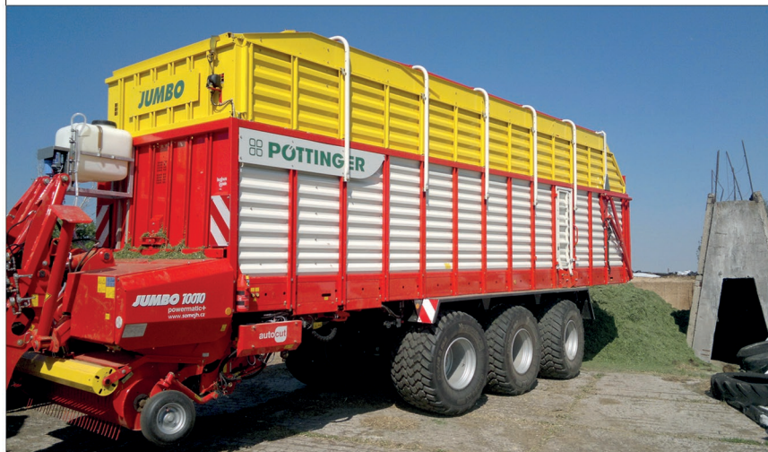
Na podvozku Tridem s nuceným řízením první a třetí nápravy návěs Jumbo 10010 L plynule sleduje traktor i na nepravidelných řádcích, při otáčení a při vjíždění a vyjíždění z pozemků. A jak se ukázalo v praxi, bezproblémové je také couvání s návěsem
