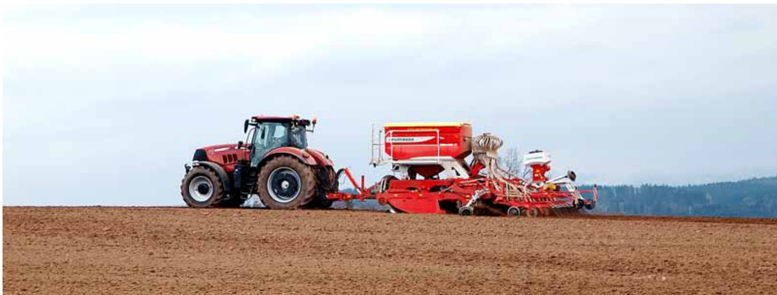
Pneumatický secí stroj Pöttinger Terrasem C4 v DS Agro Libštát je doplněn o nový secí stroj Tegosem 200 pro souběžné setí přívěvů. Kromě toho disponuje zásobníkem se zvětšeným objemem na 3950 litrů.
