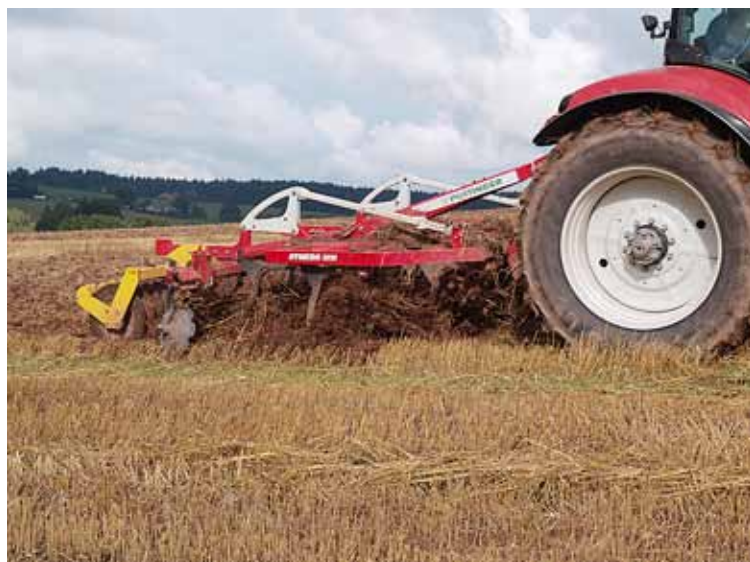
Radličkový kypříč Pöttinger Synkro 3030 Nova přebírá roli základního zpracování půdy pro ozimé i jarní plodiny. Při kypření do hloubky 27 cm pracuje s demontovanými křídly a nejlépe se osvědčily radličky Durastar Plus. Velký objem slámy na povrchu pozemku není problém.
