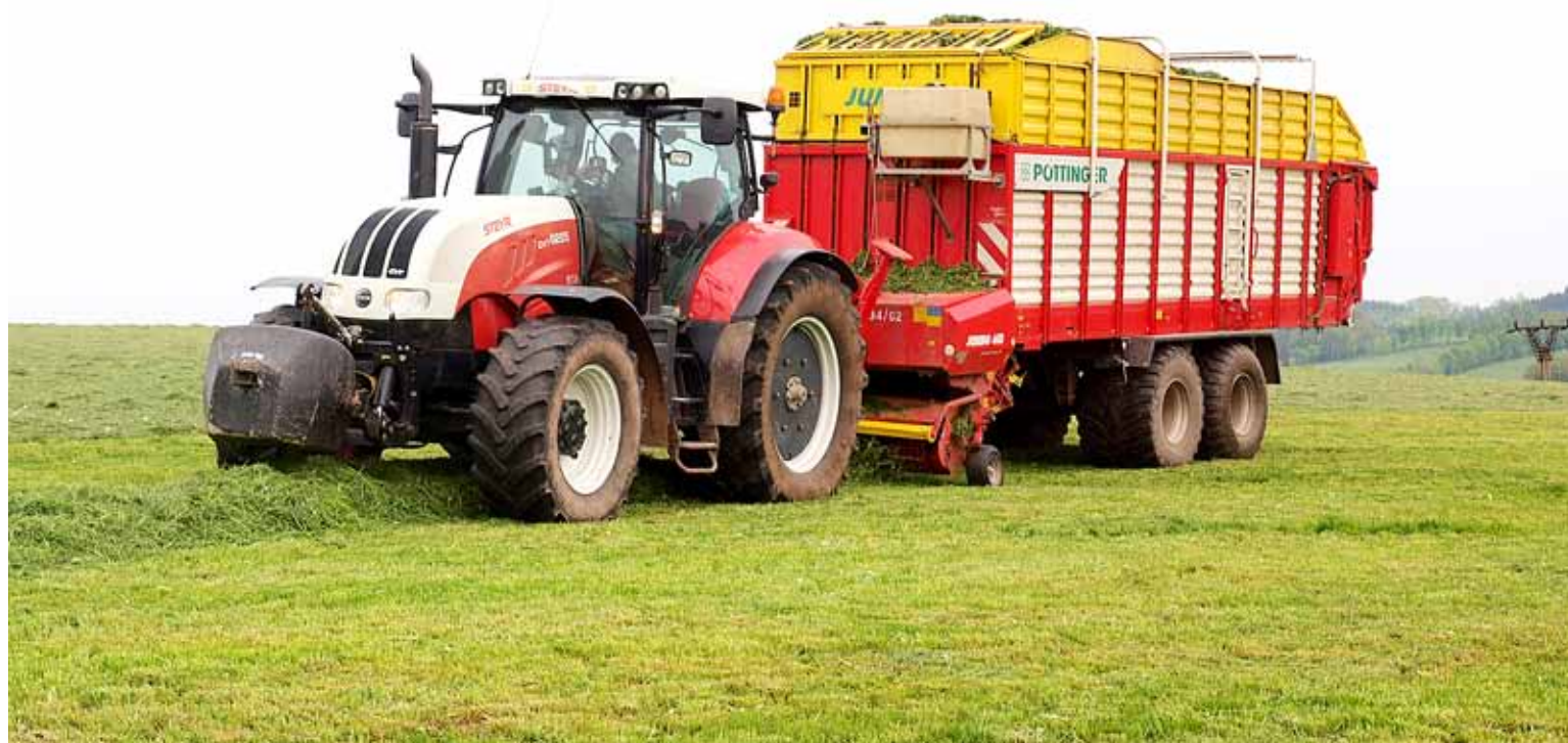
Technologie senážování s využitím senážního návěsu firmy Pöttinger se na členitých pozemcích s průměrnou velikostí šest hektarů výborně osvědčuje díky své flexibilitě.
