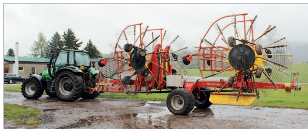
U shrnovače Pöttinger TOP 1252 C si v praxi jeho majitel cení mimo jiné také možnosti snadného ovládání teleskopického vysunutí u každého z obou předních rotorů přímo z kabiny traktoru. Takto lze snadno regulovat pracovní záběr, kdykoli je to potřeba, například i při objíždění sloupů elektrického vedení
