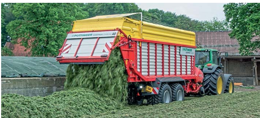
Vyprázdňovanie s dvoma dávkovacími valcami funguje bezproblémovo. Podlahový dopravník je štvordielny. Reťaz je hrubá 10 mm.
