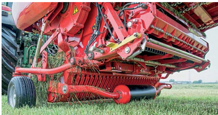
60 cm široký pogumovaný oporný valček vzadu za pickupom pomáha presnému prispôbeniu sa kontúram pôdy. Výška sa nastavuje vretenami nachádzajúcimi sa po stranách. Následne sa prispôbia valce nastaveniu kopírovacích kolies.
