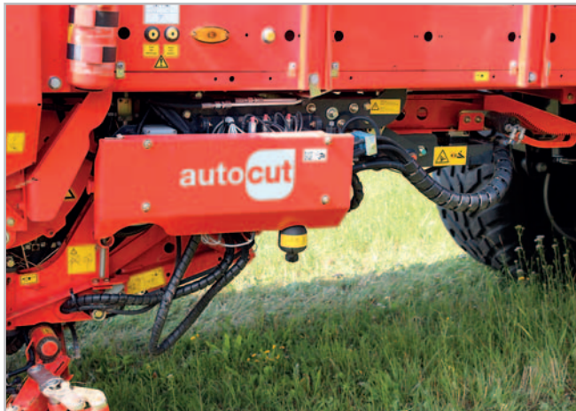
Brousíci zařízení Autocut, kterým je vybaven senážní návěs Pöttinger Jumbo 6010 L, dovoluje udržovat ostří všech nožů v nosníku Easy Move v nabroušeném stavu v průběhu celého dne a jen s minimální námahou
