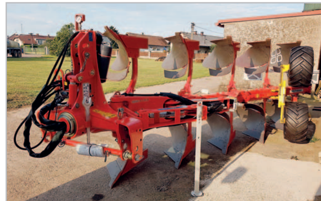
Pluh Servo 45 S Plus 4+1 s variabilním nastavením pracovního záběru se v létě ještě leskl novotou. Jde o nejsilnější provedení v oblasti nesených pluhů firmy Pöttinger, které může být agregováno s traktory o výkonu 250 až 300 k
