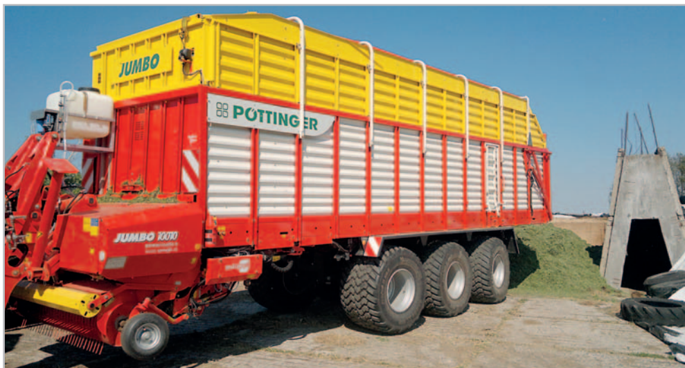
Hydropneumatically odpružený podvozek Tridem s nuceným řízením první a třetí nápravy je jednou ze silných stránek návěsu Jumbo 10010 L. Návěs překoná i hluboké nerovnosti hladce a systém odpružení účinně eliminuje rázy a vibrace od kol
