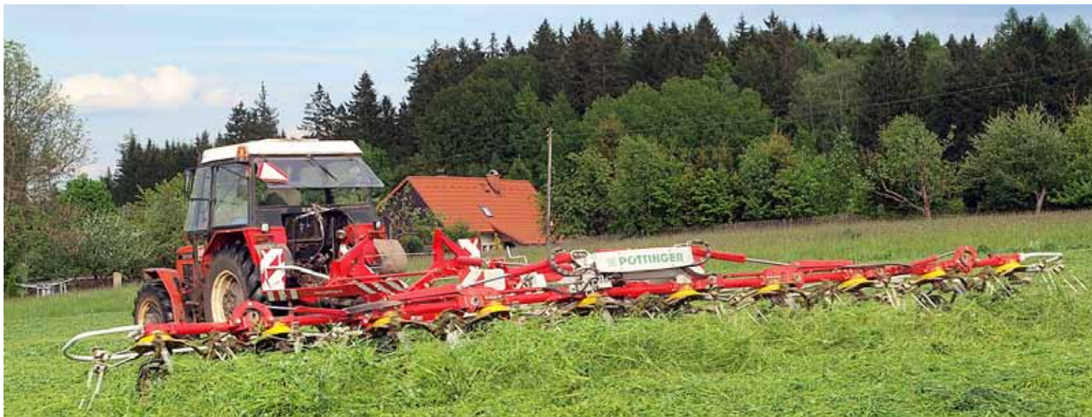
Tažené širokozáběrové obraceče HIT T firmy Pöttinger si v našich podmínkách získaly značnou popularitu. U stroje HIT 10.11 T oceňují pracovníci podniku DS Agro Libštát jeho obratnost, fungování bez ztrát prstů a šetrnou manipulaci s pící při nízké energetické náročnosti.
