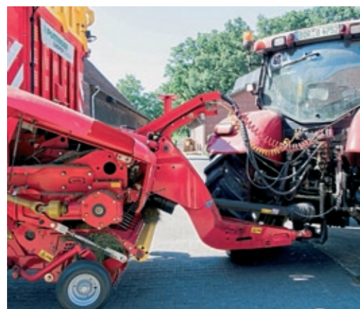
Pripojenie, vedenie hadíc a pekne úzke oje, ktoré dosahuje svetlosť až 60 cm, dostávajú vynikajúce hodnotenie!
