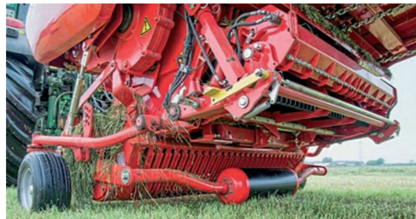
60 cm široký pogumovaný oporný valček vzadu za pickuom slúži k prispôsobeniu sa pôde. Výška má nastavuje vretenami po stranách. Následne sa prispôbia valce nastaveniu kopírovacích kolies.
