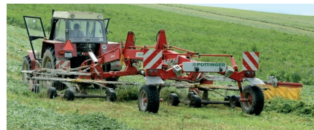
Dvourotorový zhrňovač TOP 662 so stranovým odkladaním riadku výborne zapadá do linky na zber krmovín.
