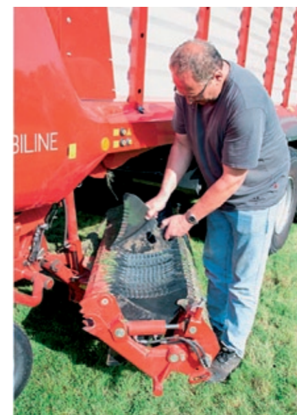
Držiak s 35 nožmi sa môže jednoducho povytiahnuť nabok. Twinblade nože sú obojstranne použiteľné.
