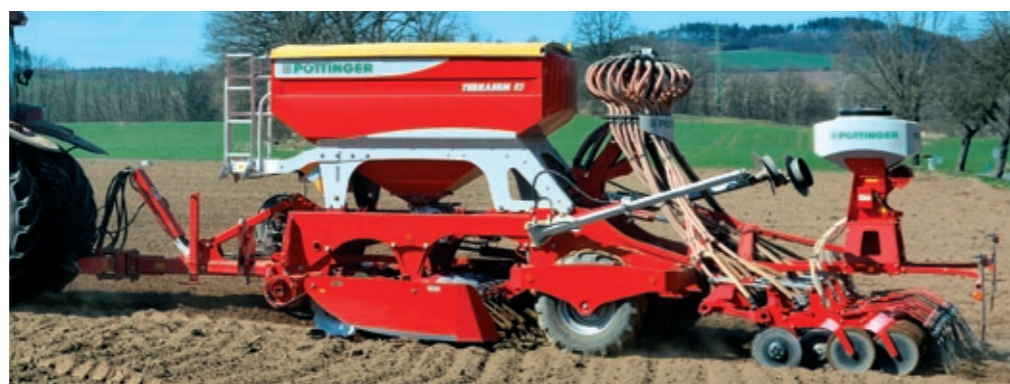
Univerzální secí stroj TERRASEM R3 ARTIS s pevnou rámovou konstrukcí a pracovním záběrem tři metry. Secí stroj doplňuje zařízení TEGOSEM pro setí meziplodin při jedné pracovní operaci.
