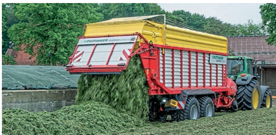
Vyprázdňovanie s dvoma dávkovacími valcami funguje bezproblémovo. Podlahový dopravník je štvordielny. Reťaz je hrubá 10 mm.
