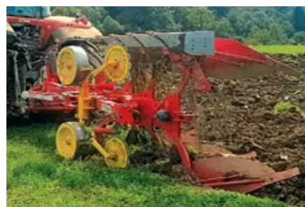
Nový pluh SERVO 35 NOVA s nonstop istením.
