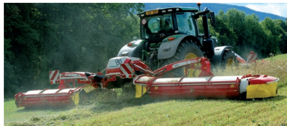
Žací kombinace NOVACAT A10 CF (CROSS FLOW) se šnekovými dopravníky a čelní žací lištou NOVACAT 351 F ED alpha motion pracuje ve společnosti FARMERS Trutnov od letošního jara.
