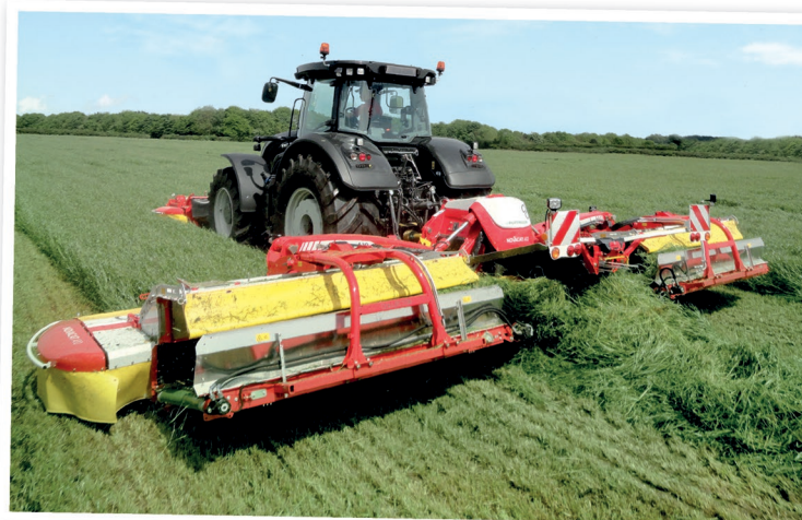
Systém pásových dopravníků Collector odkládá rovnoměrně formovaný a vzdušný řádek. Varianty ukládání hmoty jsou celkem čtyři, případně lze dopravníky kdykoli od kombinace odpojit
