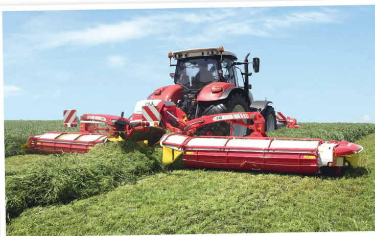
Oproti doposud rozšířeným žacím kombinacím se shazovacím dopravníkem Collector má NovaCat A10 Cross Flow se šnekovým dopravníkem výhodu v redukované hmotnosti. To přináší nižší zatížení pro půdu i menší spotřebu paliva
