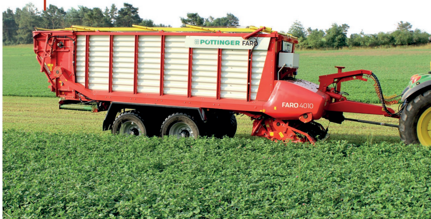
Nástavba vozu Faro 4010 D s hustě uspořádanými a přišroubovanými sloupky je dostatečně robustní. U jedné fůry pojme pět až šest tun zelené hmoty
