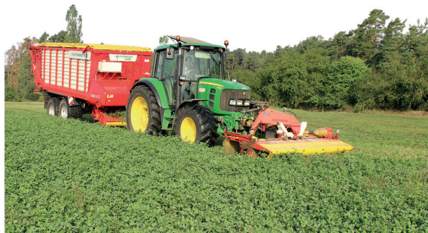
Šťavnatou vojtěšku či jinou čerstvou píci plnou vitamínů a dalších látek vozí každý den od května do října dojnícím v ZD Nečín tato souprava traktoru John Deere 6330 Standard se samosběracím návěsem Faro 4010 D a s čelně neseným žacíím strojem NovaCat 266 F firmy Pöttinger. Jedna fůra pojme pět až šest tun hmoty
