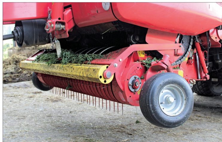
Dokonce i těžkou, mokrou a zcela nezavadlou píci dokáže sběrač plynule sbírat. Díky možnosti příčného výkyvu a kopírovacím kolům se plynule přizpůsobuje povrchu pozemku
