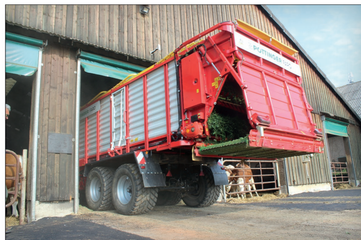
Nástavba zůstává trvale ve sklopené poloze, takže výška návěsu je pouze 2,96 m a lze s ním bez problémů projíždět stáji
