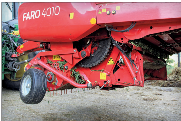
Nová modelová řada Faro 1010 disponuje zesíleným pohonem plnicího rotoru prostřednictvím jednoduchého válečkového řetězu a jistící moment pohonu stoupl na celých 1600 Nm
