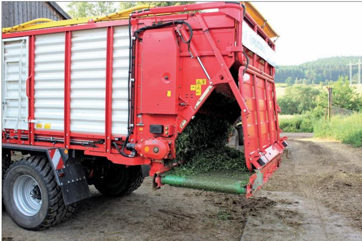
Při práci se zakládacím dopravníkem má návěs Faro 4010 D zadní stěnu fixovanou v částečně otevřené poloze. Dopravník využívá širokého pásu pro větší plynulost dopravy krmiva
