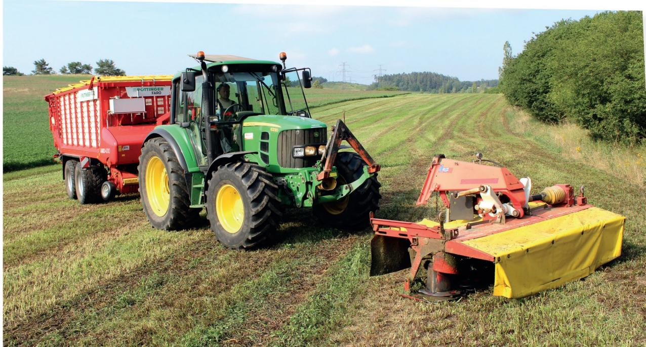
Připojení čelně neseného žacího stroje Pöttinger NovaCat 266 F do čelního tříbodového závěsu s upínacím trojúhelníkem má řidič traktoru hotové za několik minut
