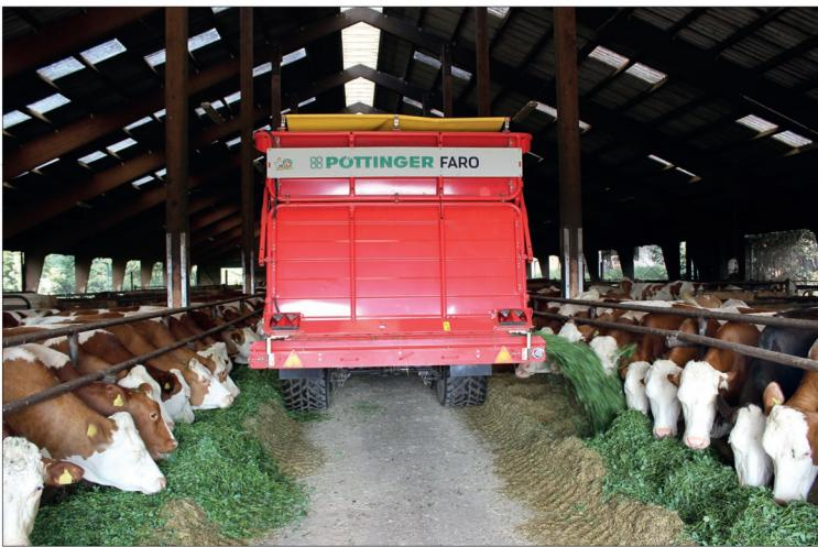
**U zakládacího dopravníku si uživatelé návěsů Faro nové generace mohou zvolit pravý nebo levý směr zakládání. Zakládací dopravník je poháněn od palubní hydrauliky, což má řadu výhod. Jeho spuštění a opětovné vypnutí je díky tomu možné přenechat automaticce vyložení návěsu**
