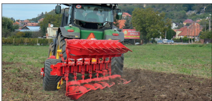
Peknú prácu predviedol aj 7-radličný pluh Servo 6.50. Rovnako ako ďalšie pôdospracujúce stroje Pöttinger sa vyrába v českých Vodňanoch. Na výber je počet radlíc od 6 do 9. Dôležitým je patentovaný systém doťaženia zadnej nápravy traktora – Traction Control, s pomocou ktorého je preukázané zníženie spotreby paliva až o 4 l/ha.
