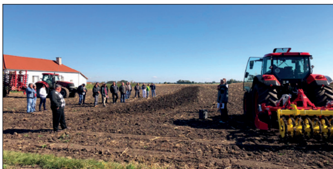
Zetor Forterra HD 150 s radličkovým kypričom Pöttinger Synkro 2520. Traktor má štandardne viacprvkovú odpruženú prednú nápravu a výborný pomer otáčania. Na kypriči Synkro predstavili tiež nové radličky Durastar plus, vyznačujúce sa veľmi dlhou životnosťou.
