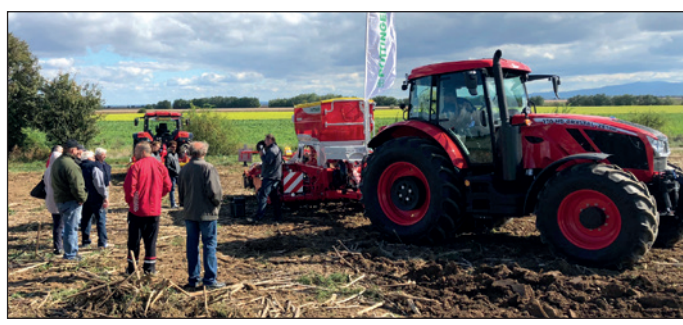
Zúčastnení ako prví na Slovensku mohli vzhliadnuť a prakticky si vyskúšať vlajkovú loď Zetoru - CRYSTAL HD 170. Traktor poháňa 6 valcový motor s výkonom 171 PS, s ECO prevodovkou 40 km/h a prevodovými stupňami 30/30. Je vybavený aj nezávisle odpruženou prednou nápravou, elektronicky ovládanými vnútornými vývodmi hydrauliky a mnohými ďalšími inovatívnymi prvkami. Všetky vylepšené vlastnosti smerujú k nízkym nákladom na prevádzku i údržbu.
