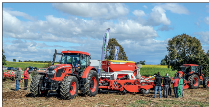
Vlajkovou súpravou celého podujatia bol nový traktor Zetor Crystal 170 HD a univerzálny sejač Pöttinger Terrasem R3. Sejačka bola vybavená novinkou – vlnovitými wave diskami, ktorými sa spracováva pôda v 5 cm páschoch, čo má veľký význam napríklad v suchých podmienkach.
