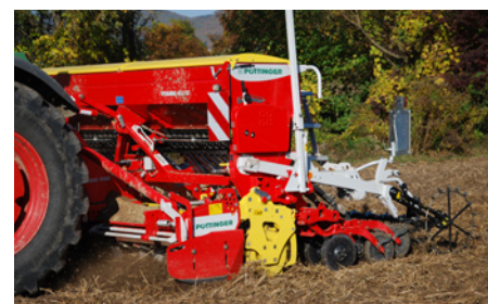
Na poliach v okolí Kuzmíc sa osvedčila sejba s rotačnými bránami. Používajú ich v kombinácii so sejačkou alebo samostatne.
