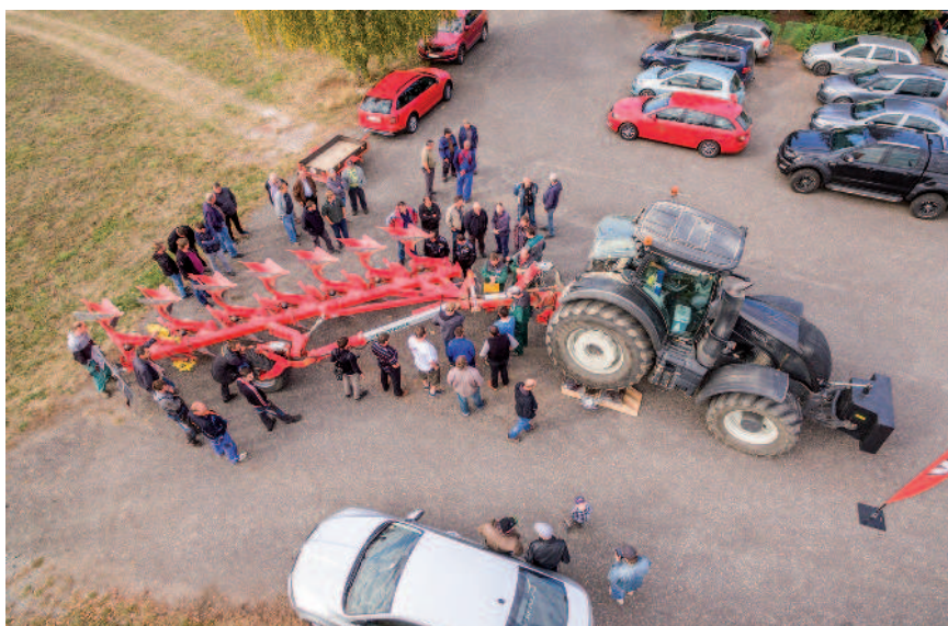
Traktor byl umístěn v šikmé poloze a na vahách, aby se imitoval náklon při orbě
