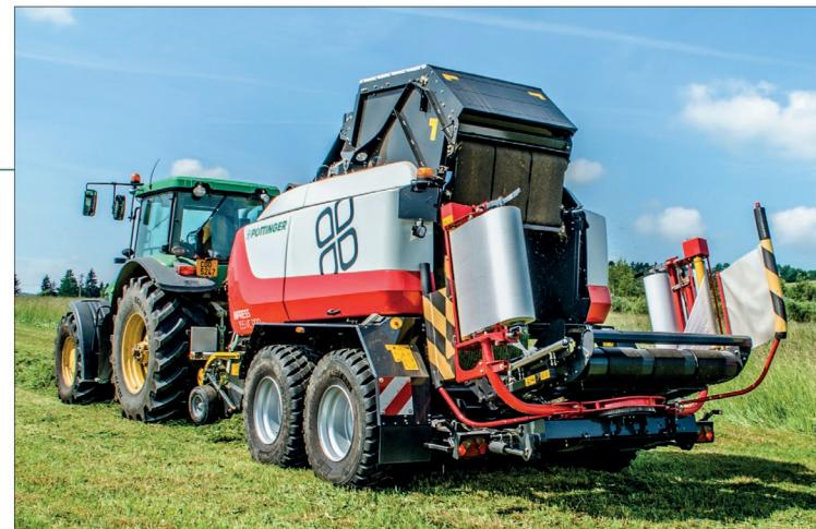
*Jakmile je balík hotový, zadní stěna komory se otevře do výšky, odpovídající právě nastavenému průměru balíku, který je předán nejprve na podávací stůl a z něj se hned přesouvá na ovíjecí stůl. Tato fáze funguje naprosto bezproblémově*
