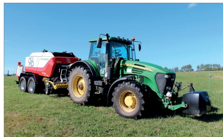
*V podniku AGRO SVOBODA je kombinace lisu s ovíječkou firmy Pöttinger agregována s traktorem John Deere 7820, jehož výkon 158 kW/215 k je pro stroj dostatečný i při práci na svažitých pozemcích*
