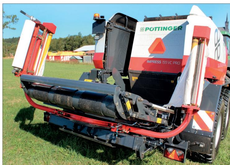
*Dvouramenná ovíječka umožňuje snadnou výměnu rolí díky nízké výšce ramen. Obsluha si může nastavovat překrytí fólie v rozsahu od 50 do 70 procent*
