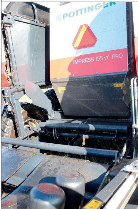
**Provozní spolehlivost předávání balíku z lisovací komory na stůl ovýječky je základní podmírkou úspěšného nasazení kombinaci lisu s ovýječkou na jednom podvozku. U stroje Impress 155 VC Pro má tuto práci na starosti přenosová jednotka s lineárním pohybem. Podle zkušeností z Dolního Dvořiště pracuje plynule a naprosto bez závad**
