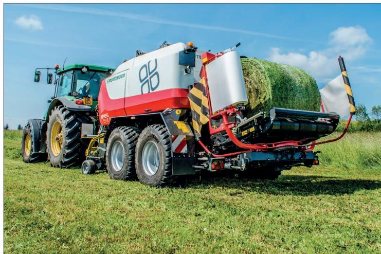
**Kombinace Impress 155 VC Pro umožňuje sklizeň zavadlé i suché hmoty, přičemž lze využívat přednosti odkládání balíků po dvou na jedno místo, čímž se usnadňuje následná manipulace s balíky. Výhodou je také možnost snadného řazení počtu nožů v záběru na nosníku Flexcut**
