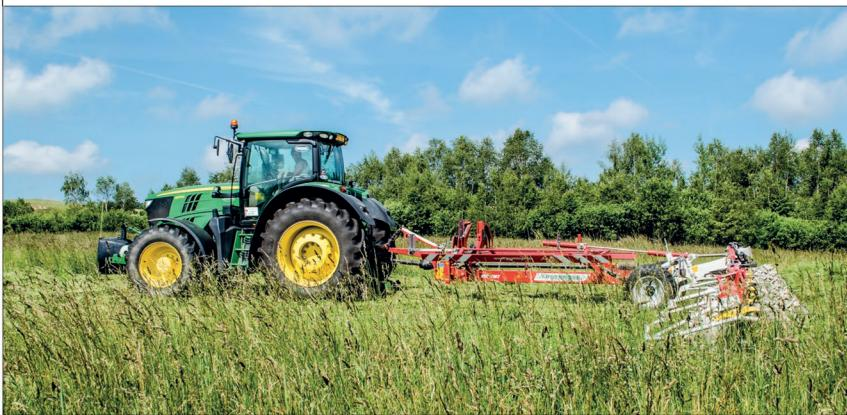
Tažený obraceč HIT 12.14 T kopíruje terén díky vlastnímu podvozku zcela nezávisle na traktoru. Obsluha využívá možnosti nastavení sklonu rotorů, ale i funkce krajového obracení, nabízené k této strojům, jako výbava na přání. Díky vykývnutí krajního rotoru není píce na okrajích luk vrhána mimo prostor pozemku
