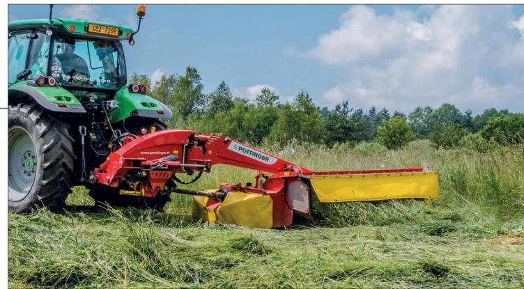
U bočně nesených žacích strojů NovaCat H ED využívá firma Pöttinger originální řešení: přídavná pístnice v závěsu umožňuje snadné nastavení optimální pracovní polohy a zároveň usnadňuje agregaci žacího stroje s traktorem. Žací stroj má středové zavěšení, takže může lehce kopírovat nerovnosti terénu
