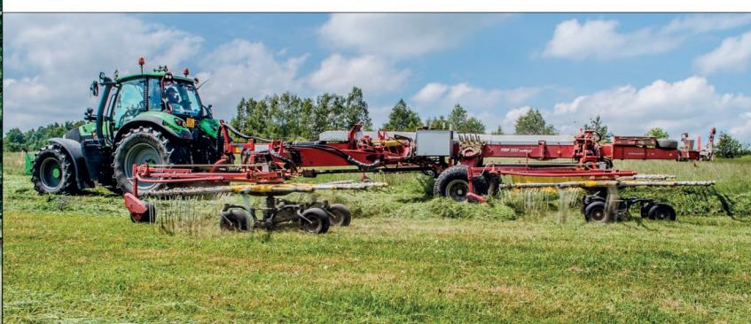
Čtyřrotorový shrnovač TOP 1252 C se záběrem až 12,5 m pracuje na největších pozemcích. Spolu s dalšími dvěma shrnovači značky Pöttinger formuje pravidelné řádky, které mají svůj podíl na výkonnosti a kvalitě práce lisu
