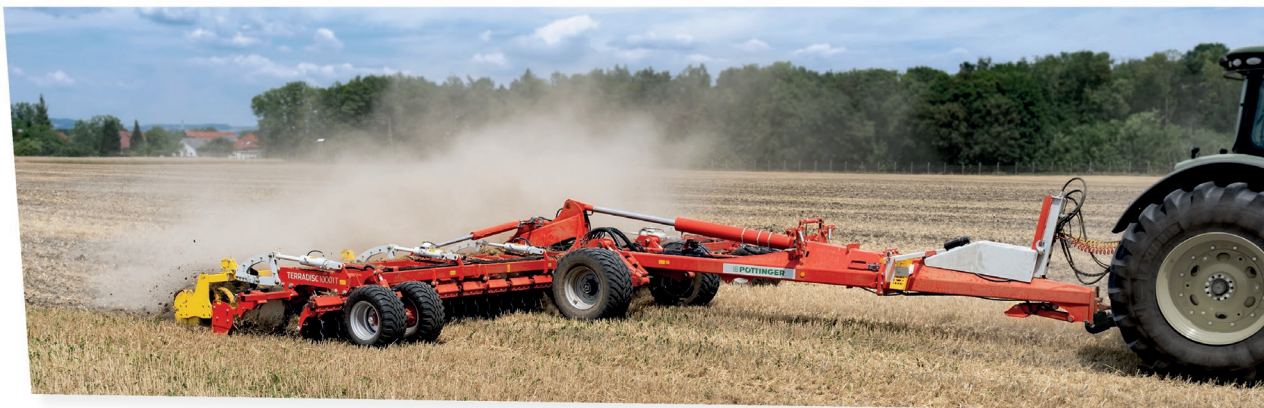
Firma Pöttinger uvolňuje pro mezinárodní trh velké verze talířových bran Terradisc 8001 T a 10001 T se záběrem osmi a deseti metrů. Stroje umožňují nastavovat hloubku záběru v rozmezí od 5 do 15 cm, takže jsou vhodně využitelné k podmínkám či k přípravě půdy před setím v bezorebných technologiích
