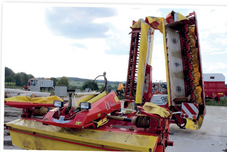
Se žací kombinací A9 ED dokážou zkušené obsluhy z Bražné posekat za 8–10 hodin 50 hektarů při spotřebě pouze dva až tři litry na hektar
