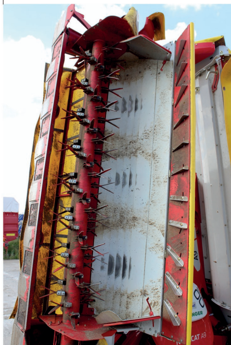
Hmotu je rotorem kondicionéru s prsty z kalené oceli dopravována přes plechy konstruované tak, aby rozhazovaly píci po celém pracovním záběru. Prsty jsou uspořádány spirálově pro rovnoměrné zatížení; každou lamelu lze individuálně nastavit
