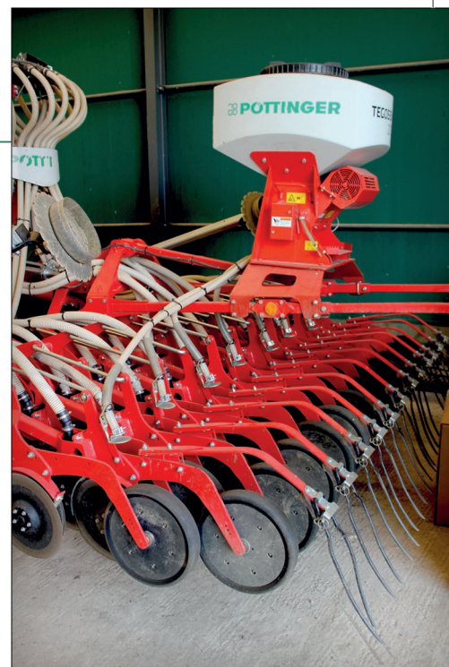
Výsev krycí plodiny a zároveň i podsevu při jednom přejezdu dokáže zabezpečit secí stroj Tegosem 200. Vývody s rozrázecími plechy jsou uloženy v prostoru secích btek. Zásobník pojme 200 l osiva
