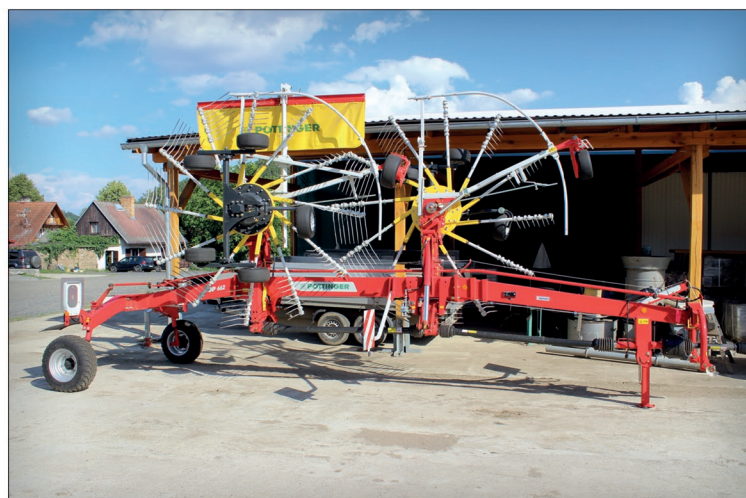
Na členitých loukách s nerovným povrchem má za úkol formování řádku shrnovač TOP 662 s dvojicí rotorů o průměru 3,07 m (na snímku). Stabilní provedení ramen a vhodné vedení prstů přímo pod ramenem zajišťují spolehlivé zpracování hmoty
