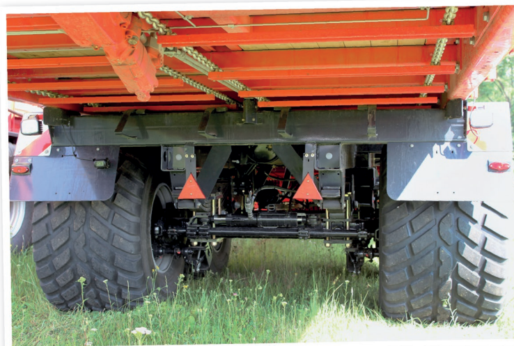
Tandemová náprava vozu Jumbo 7210 D s parabolickými pružinami a kyvadlem zaručuje návěsu podle vyjádření řidiče vynikající jízdní vlastnosti na poli i na silnici. Široké pneumatiky Nokian a vlečné řízení zadní nápravy slouží pro šetrné působení na půdu a travní drn
