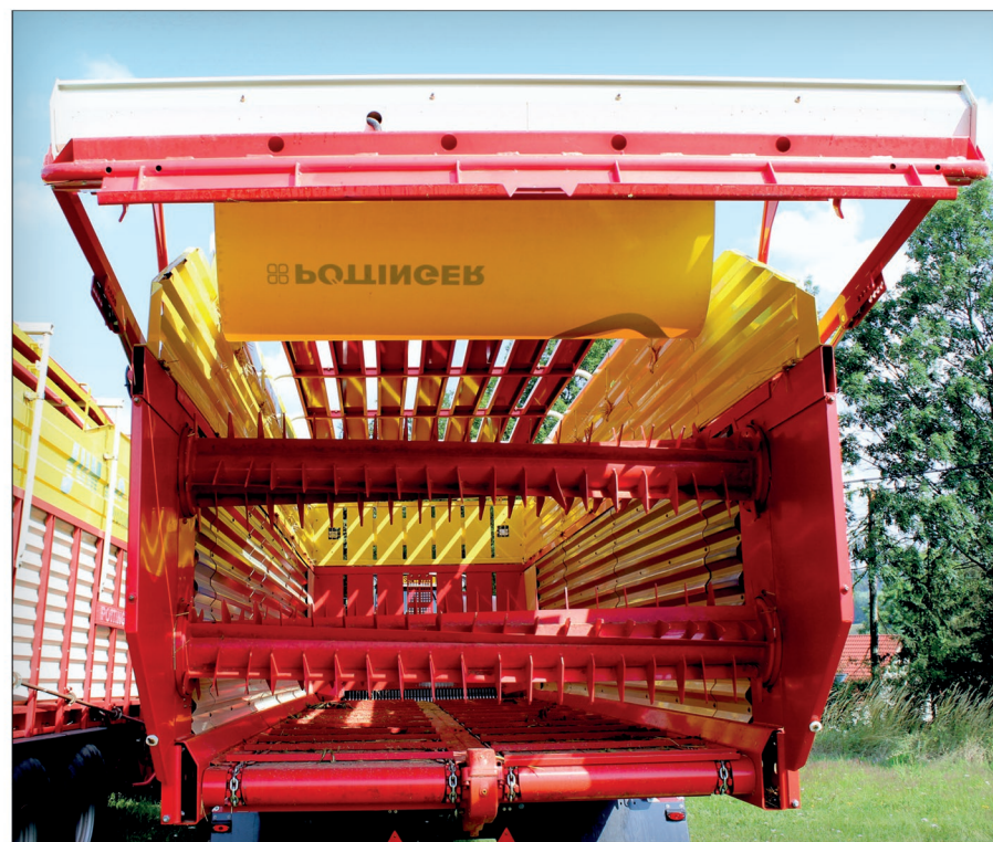
Úhel otevření zadní stěny je nastavitelný ze sedadla traktoru. Také pohon rozdrůžovacích válců je zesílený, nicméně vyprazdňování probíhá díky malému průměru válců rychle a plynule. Podlahový dopravník má dvoustupňový pohon
