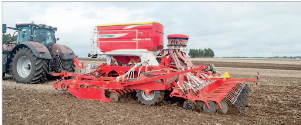
Pneumatický secí stroj Terrasem firmy Pöttinger představuje vhodný stroj pro zakládání porostů plodin na polích, kde je režim kolejových meziřádků nepravidelný, či jsou meziřádky zakládány jako zdvojené
