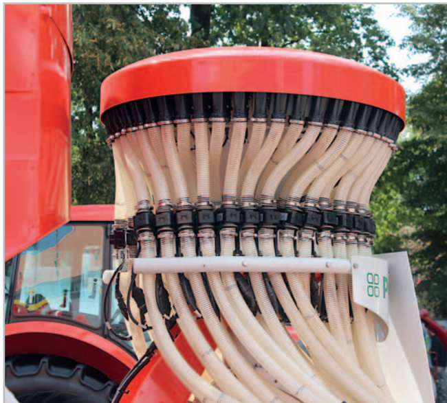
Inteligentní distribuční systém IDS otvírá nové možnosti v nastavení setí a kolejových řádků jednoduchými povely z kabiny. Přes ovládací panel Power Control, terminál CCI anebo ISOBUS terminál traktoru lze ovládat setí v kterémkoliv vývodu (řádku) či vypínat setí v polovině záběru
